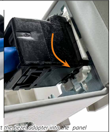
28 Modulaufnahme in Panel einsetzen / Insert the bezel adapter into the panel
