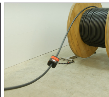
RM35 s odvíječem RUNPOLIFER 4500 a kabelem 1 x 300 mm 2
